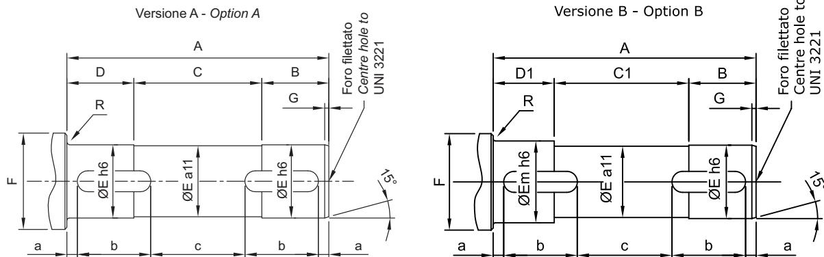
Linguette dimensionate su E in accordo con UNI 6604 - Keys dimensioned on E to UNI 6604
